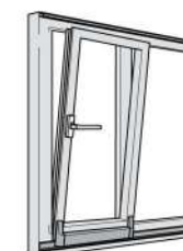
Posición de oscilante Girando la manivela al 90°, las puertas se abren automáticamente a la posición de ventilación
