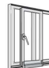
Posición de corredera Girando la manivela al 45°, las puertas se cierran automáticamente y entran en deslizamiento
