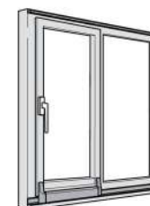
Posición cerrada El sistema PSK proporciona la presión máxima de la hoja al marco en la posición cerrada
