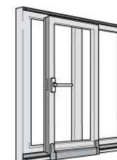
Posición de corredera Girando la manivela hasta el 90°, las hojas se moverán a la posición de apertura
