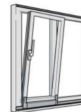
Posición de oscilante Girando la manivela al 90°, las hojas se pueden abrir para ventilar
